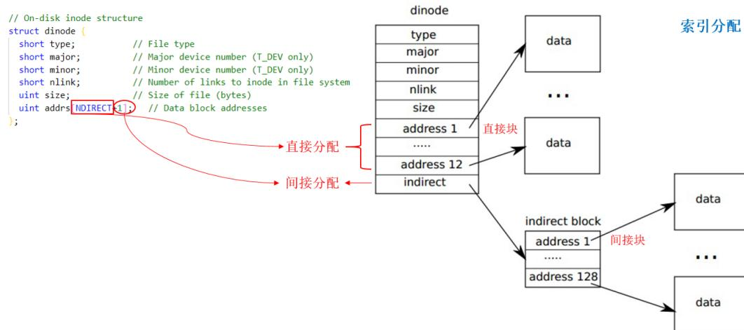
其中，最开始的 NDIRECT 个块是直接索引块，接下来的 KINDIRECT 个块没有直接存在 inode 中，而是存在 addrs 最后一个地址指向的数据块中，称为间接块。
