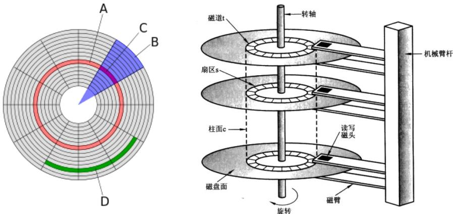
在计算机磁盘存储器中，比如传统的机械硬盘驱动器 (HDD)由多个盘片构成。每一个盘片有两个盘面(surface); 如上图，每一个盘面由多个同心环构成，其中每一个同心环就是一个磁道(track); 而每一个磁道又被分为多个扇区(sector)。
