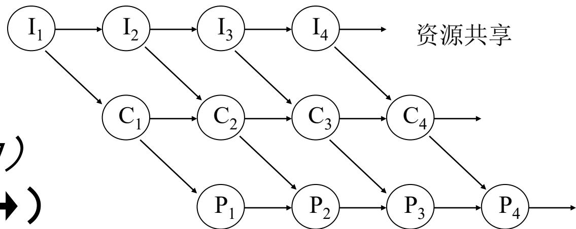
*I:* 输入进程 *C:* 计算进程 *P:* 输出进程
